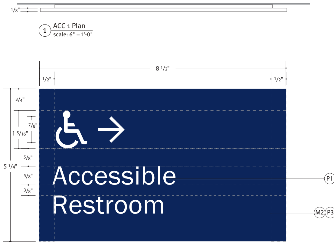
2 ACC 1 Elevation (Standard Palette) scale: 6" = 1'-0"
